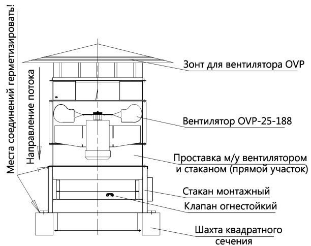
установка на монтажном стакане с огнестойким клапаном
