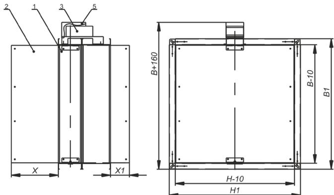
ЛКФ-2 с электромагнитным приводом
