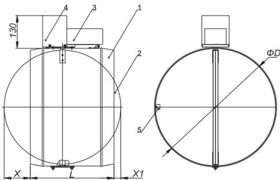
**LKF-1 с электромагнитным приводом
