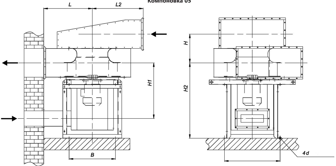
Установка вентиляторов VR 80-75-...-PR на улице (крепление к стене для типоразмеров 355 - 630)
