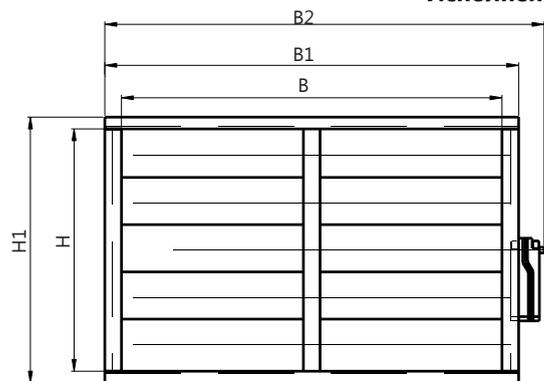
B2=B1+80мм (для реверсивного привода с плавным регулированием);
