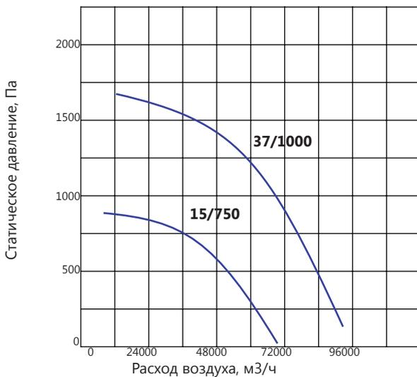
Характеристики вентиляторов приведены для температуры воздуха  $t=20^{\circ}\text{C}$ .
