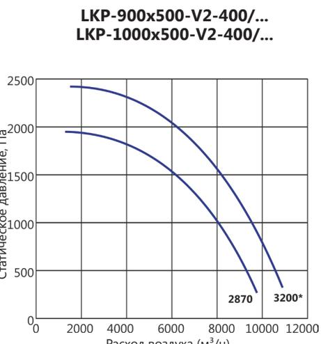
\* Максимальная частота вращения вентилятора (достигается при помощи преобразователя частоты)
