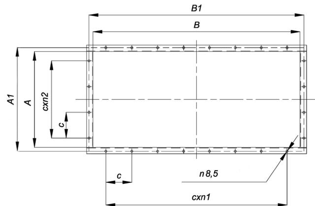
**ГАБАРИТНЫЕ И ПРИСОЕДИНИТЕЛЬНЫЕ РАЗМЕРЫ ВЕНТИЛЯТОРОВ VR 80-75-...-PR**
