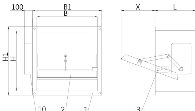
B и H - установочные размеры клапана, мм;
