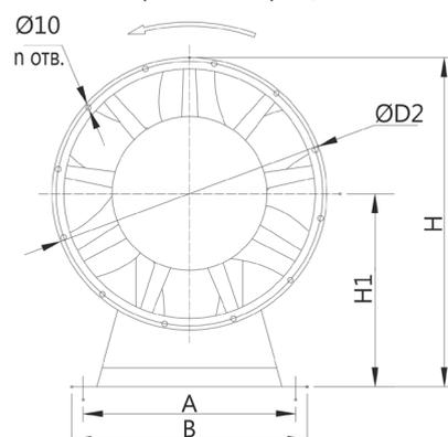
**Габаритные и установочные размеры вентиляторов**
