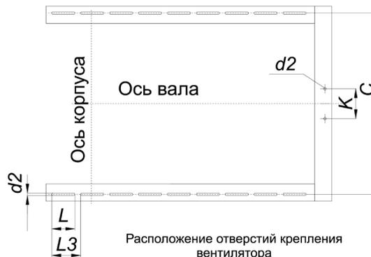
Расположение отверстий крепления вентилятора
