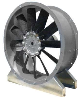
Вентиляторы UVO состоят из рабочего колеса, стального корпуса и асинхронного электродвигателя, размещенного в корпусе. Рабочее колесо выполнено с поворотными лопатками, угол установки и количество лопаток варьируются для получения для получения максимального КПД для заданного режима работы. Лопатки выполнены объемными из высокопрочных композитных материалов.
