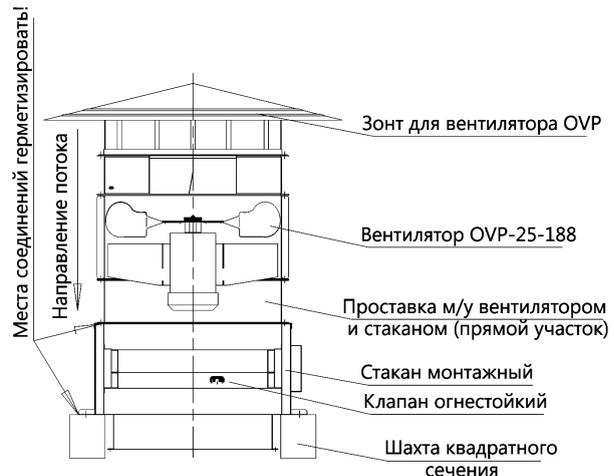
установка на монтажном стакане с огнестойким клапаном
