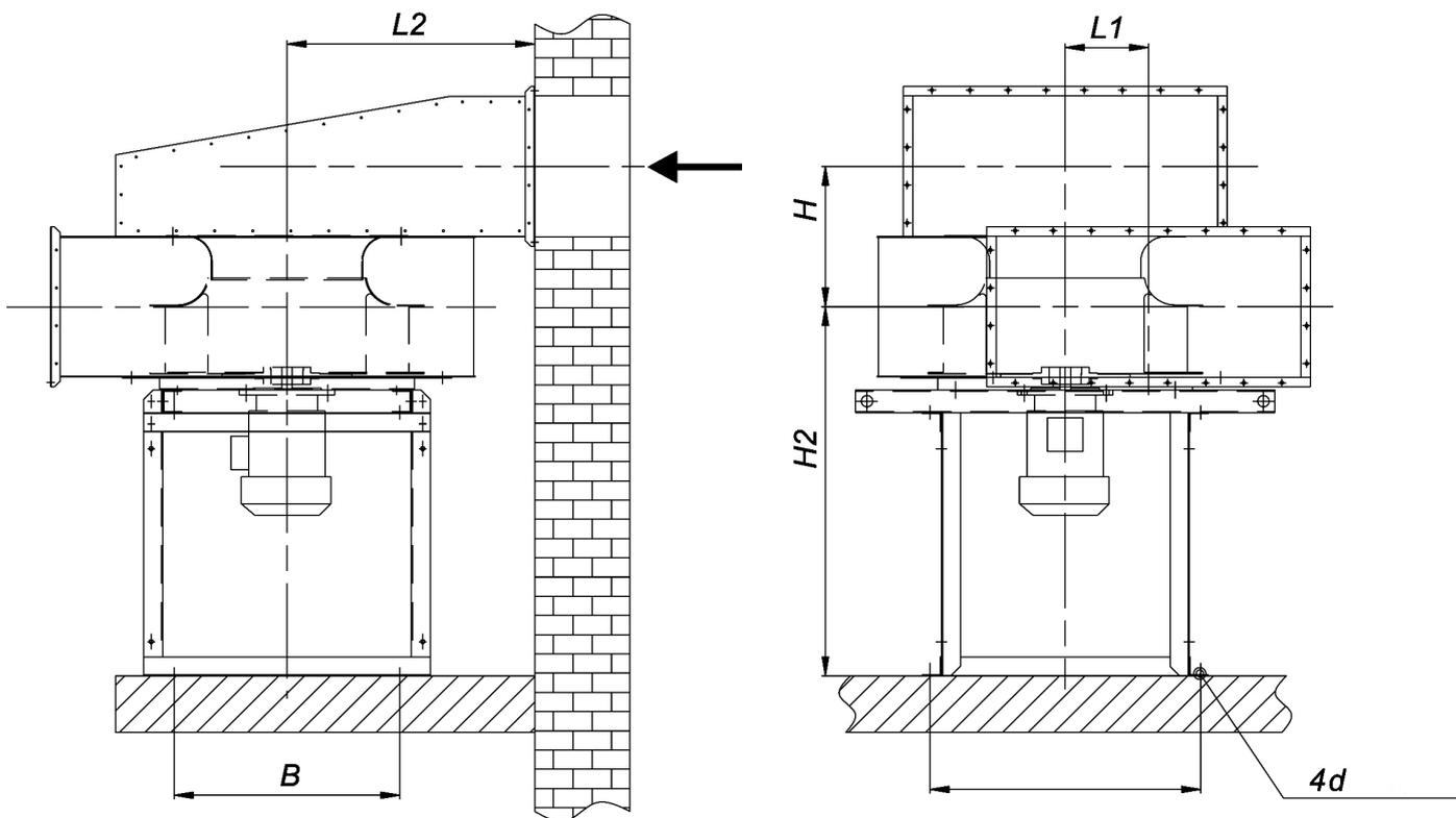
**Габаритные и установочные размеры вентилятора VR 80-75-D-...-PR**
