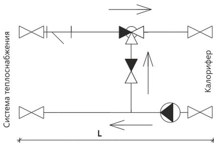
**Схема 2 - на базе трехходового клапана (независимая схема)**
