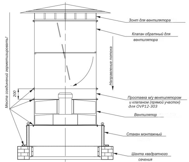
Габаритные размеры вентиляторов UVO в крышном исполнении
